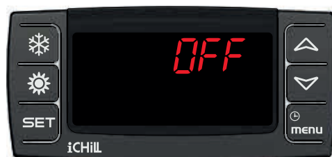
Anzeige im Standby-Modus bei Geräten mit externem Thermostat / Hygrostat.
