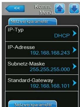
Die nachfolgenden Netzwerkeinstellungen werden nur für die Kommunikation über die integrierte BACnet IP Schnittstelle benötigt.
