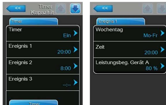
Aktivieren Sie die Timerfunktion ("Timer Kapazität : **Ein**"). Bei aktivierter Timerfunktion können anschliessend bis zu acht Schaltzeitpunkte (Ereignis 1... Ereignis 8) mit unterschiedlichen Leistungsbegrenzungen definiert werden. Jeder Schaltzeitpunkt ist definiert durch einen Wochentag bzw. Wochentagbereich, die Schaltzeit und die Leistungsbegrenzung (in % bezogen auf die maximale Befeuchterleistung).
