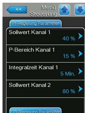
Lassen Sie die Timerfunktion deaktiviert ("Timer Sollwert: **Aus**") oder deaktivieren Sie die Timerfunktion falls nötig. Legen Sie anschliessend mit dem Parameter "Sollwert Kanal 1" den fixen Feuchtesollwert fest (Werkseinstellung: **40 %rF**, Einstellbereich: **5...95 %rF**).
