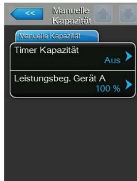
Lassen Sie die Timerfunktion deaktiviert ("Timer Kapazität : **Aus**") oder deaktivieren Sie die Timerfunktion falls nötig. Legen Sie anschliessend mit dem Parameter "Leistungbeg. Gerät A" die fixe Leistungsbegrenzung in % bezogen auf die maximale Befeuchterleistung fest (Werkseinstellung: **100 %**, Einstellbereich: **20 ... 100 %**).
