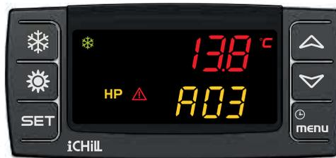
Eine Störungsanzeige wird am Display durch ein
