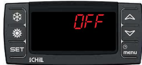
Anzeige im Standby-Modus bei Geräten mit externem Thermostat / Hygrostat.
