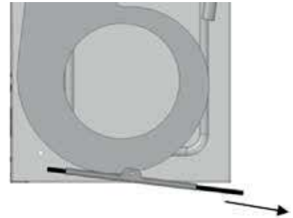
Ziehen sie den Filter nach schräg unten heraus.
