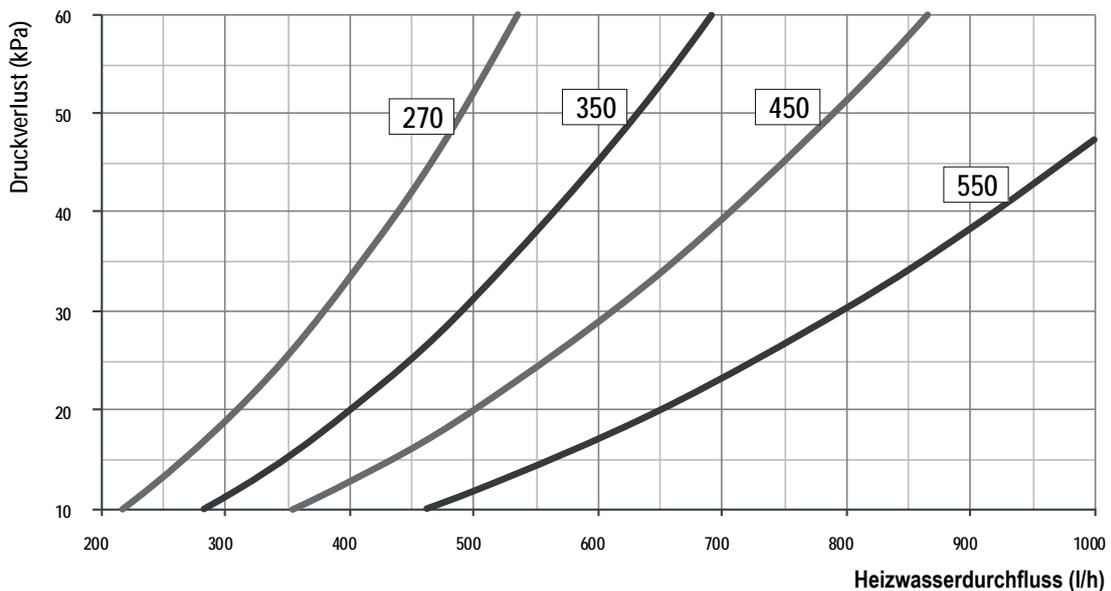
3.3.1 Kennlinien AC-Ventilatoren (Standard)
