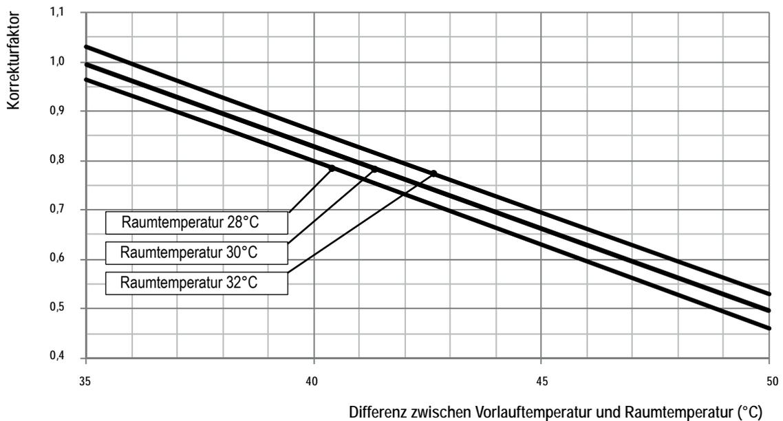
Die Heizleistung des PWW-Heizregisters, unter anderen als den Nominalbedingungen, kann durch Multiplikation der Nominalleistung mit dem entsprechenden Korrekturfaktor ermittelt werden.
