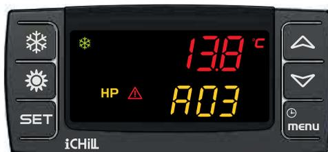
Eine Störungsanzeige wird am Display durch ein
