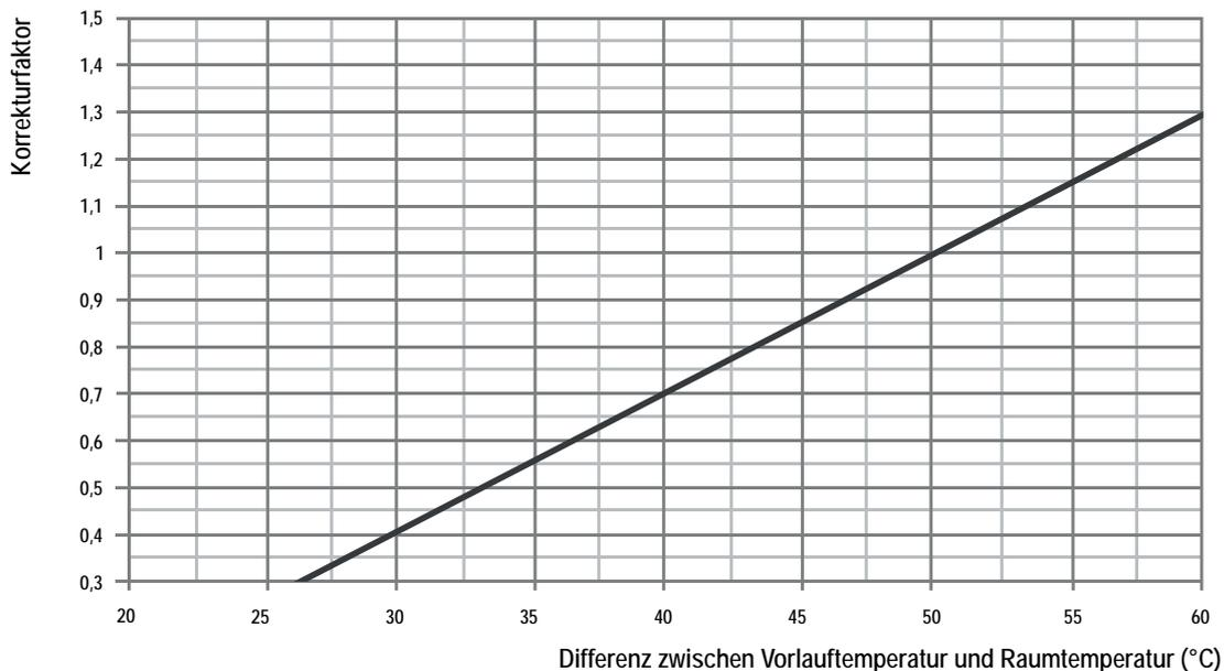
Die Heizleistung des PWW-Heizregisters kann unter anderen Bedingungen als den Nominalbedingungen, durch Multiplikation der Nominaleistung mit dem entsprechenden Korrekturfaktor, ermittelt werden.
