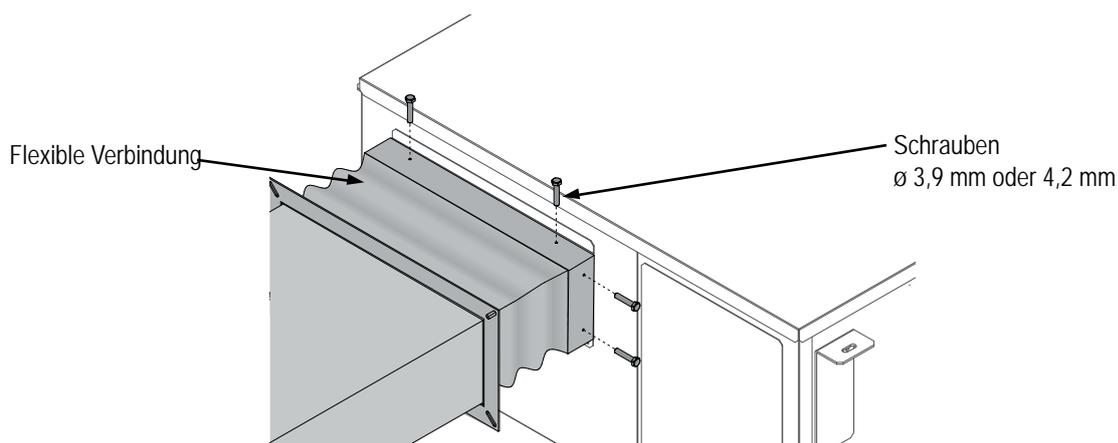
Fixieren der Lüftungskanäle an der Zu- und Abluftseite
