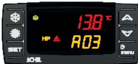
Eine Störungsanzeige wird am Display durch ein
