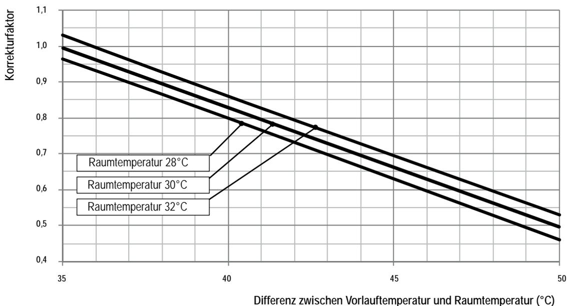
Die Heizleistung des PWW-Heizregisters kann unter anderen Bedingungen als den Nominalbedingungen, durch Multiplikation der Nominalleistung mit dem entsprechenden Korrekturfaktor, ermittelt werden.
