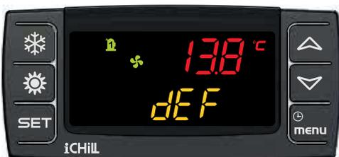
Anzeige der Abtauung bei Geräten mit einem extern angebrachten Thermostat / Hygrostat (Option).
