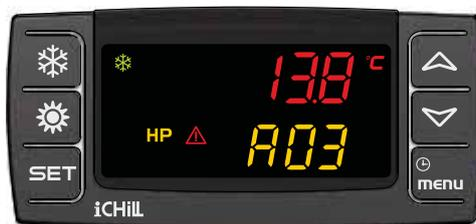
Eine Störungsanzeige wird am Display durch ein
