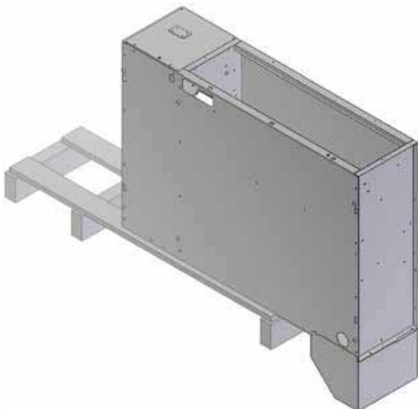
Verwenden Sie zur Montage des ersten Stützfußes die Palette der Transportverpackung als Unterstützung.
