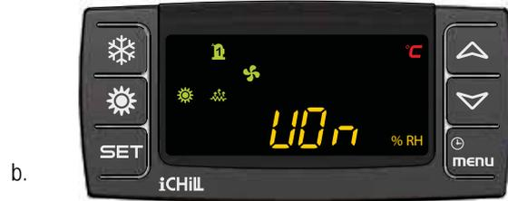
Halten Sie die Taste
