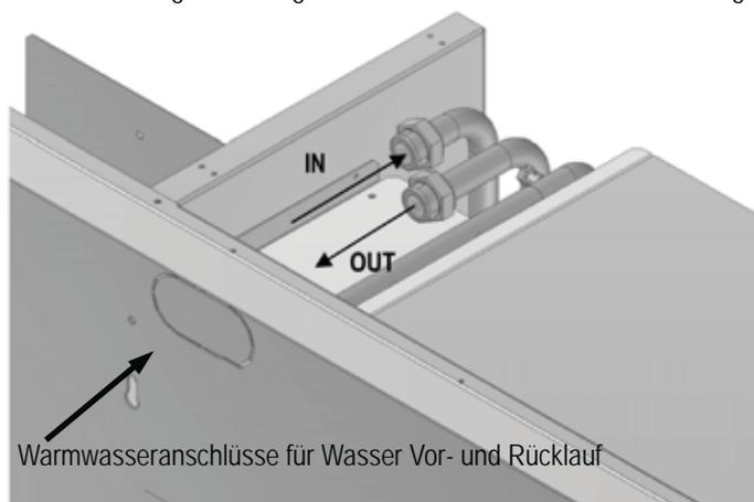
Warmwasseranschlüsse für Wasser Vor- und Rücklauf
