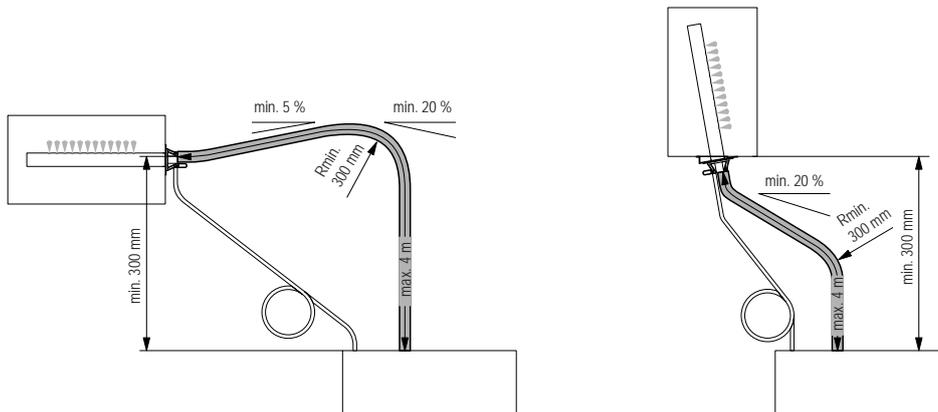
Dampfschlauch mit einer **minimalen Steigung von 20%** über eine **minimale Höhe von 300 mm** und anschliessend mit einer **minimalen Steigung von 20%** und/oder einem **minimalen Gefälle von 5%** zum Dampfverteiltrrohr führen.
