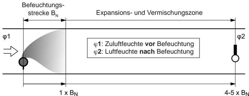
Die Bestimmung der Befeuchtungsstrecke " $B_N$ " hängt von verschiedenen Faktoren ab. Zur einfachen Bestimmung der Befeuchtungsstrecke " $B_N$ " kann die nachfolgende Tabelle verwendet werden. Die in der Tabelle angegebenen **Richtwerte** beziehen sich auf einen Zulufttemperaturbereich von 15 °C bis 30 °C.
