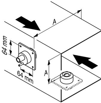
Die **Dampfdüse W21** kann horizontal oder vertikal in den Lüftungskanal eingebaut werden. Von der Düsenöffnung zur gegenüberliegenden Kanalwand muss ein **Mindestabstand (A) von 200 mm** eingehalten werden.
