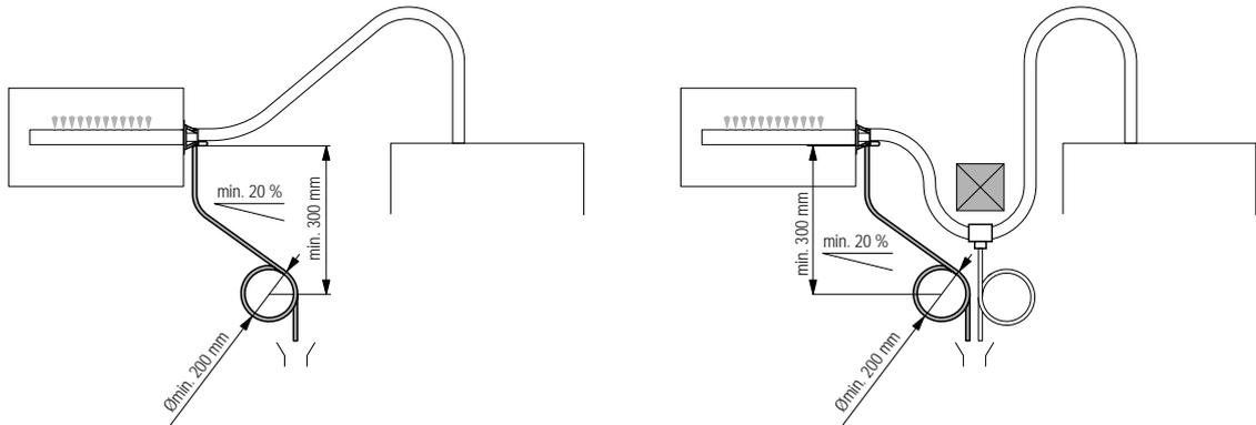
Kondensatschlauch mit einem **minimalen Gefälle von 20 %** über einen **Siphon** (Schlauchbogen **min. Ø200 mm**) nach unten direkt in einen Ablauftrichter führen.
