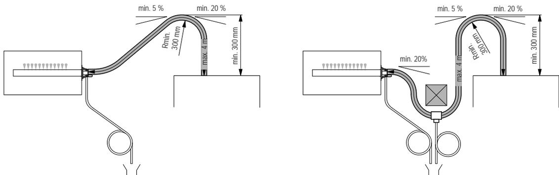
Dampfschlauch mit einer **minimalen Steigung von 20%** mindestens **300 mm über die Oberkante** des Dampf-Luftbefeuchters und anschliessend mit einem **minimalen Gefälle von 5%** nach unten zum Dampfverteiltrrohr führen.
