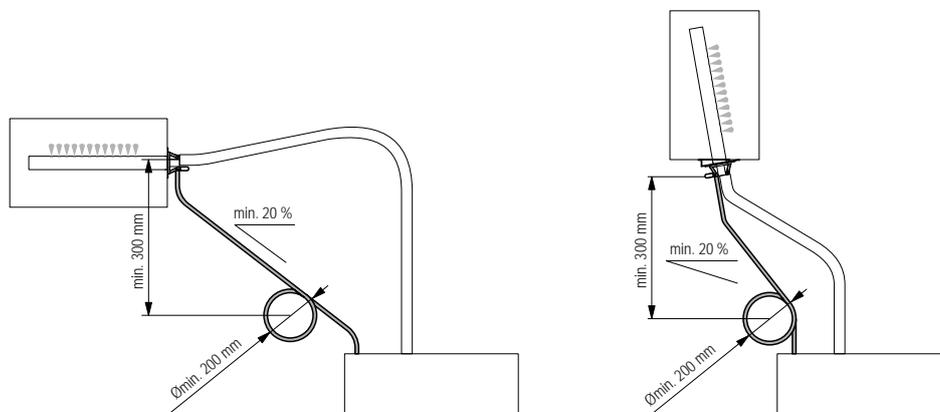
Kondensatschlauch mit einem **minimalen Gefälle von 20 %** über einen **Siphon** (Schlauchbogen **min. Ø200 mm**) nach unten zum Gerät führen. Dort durch den Durchbruch auf der Geräteoberseite ins Gerät führen und ca. 2 cm in die dafür vorgesehene Bohrung im Wasserbecher einschieben.
