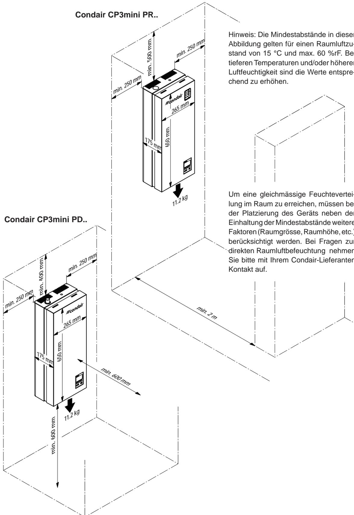
Um die **korrekte Funktion** des Dampf-Luftbefeuchters zu gewährleisten und einen **optimalen Wirkungsgrad** zu erreichen, sind für die Platzierung des Dampf-Luftbefeuchters folgende Punkte zu beachten und einzuhalten:
