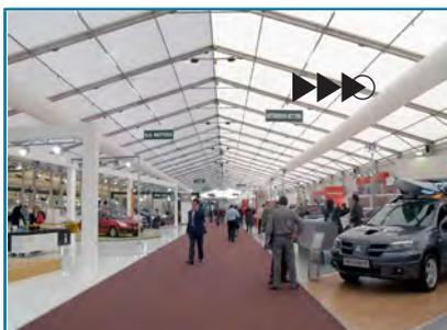
Die Vorteile der Verwendung von textilen Luftverteilsystemen zur Kühlung oder Beheizung von Großraumzelten oder Baustellen sind offensichtlich. Leichte Deckenkonstruktionen können textile Auslässe mit einem Gewicht von ca. 100 bis 300 g/m<sup>2</sup> problemlos tragen.
