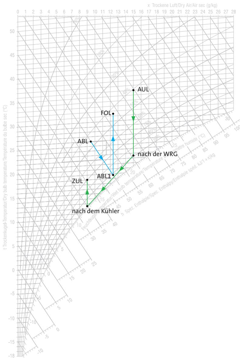
Eine Möglichkeit zur Erzeugung regenerativer Kälteleistung ist die indirekte Verdunstungskühlung in RLT-Anlagen.
